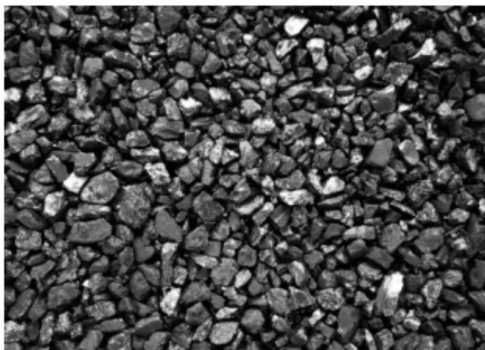
Большая удельная поверхность частиц гидроантрацита способствует более качественной фильтрации воды.
